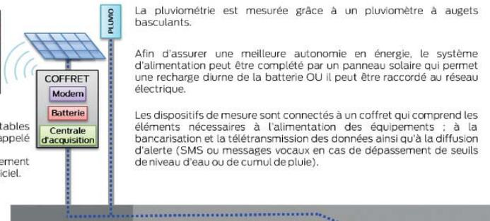
La pluviométrie est mesurée grâce à un pluviomètre à augets basculants.
